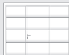
Symmetrisk opstilling med BRB 2.000 - 3.500 mm - kun i midten
